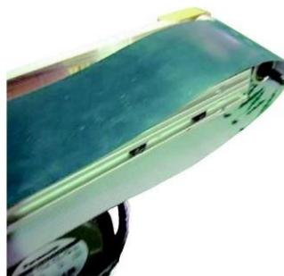
6. Installer la nouvelle courroie en fonction du sens de convoyage ! Respecter le marquage du sens de convoyage au dos de la courroie !
