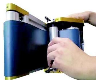
13. Régler ensuite la tension de la courroie avec les vis de réglage de tension ! Ce faisant, veiller à ce que la courroie ne fasse pas de courbes sur un côté.
