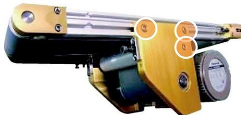
9. Retenir le déroulement de la courroie autour des galets pour l'installation ultérieure de la nouvelle courroie !
