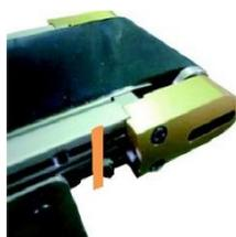
3. Desserrer la vis de réglage de tension des deux côtés ! La courroie se desserre en même temps que le raccord à vis !
