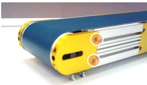
4. Décrocher le couvercle de la poulie de la courroie !
