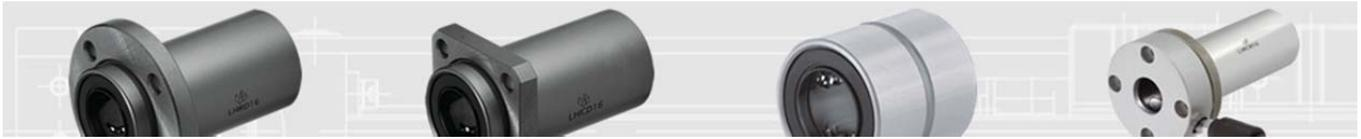
Les douilles à billes sont des roulements fiables et économiques basés sur le principe du roulement à billes. Les billes, sous charge, circulent de façon prisonnière entre la douille et l'arbre pour revenir à leur point de départ en suivant un circuit « oval », ceci permet un guidage linéaire dont la course maximum est limitée par la longueur de l'arbre lui-même.
