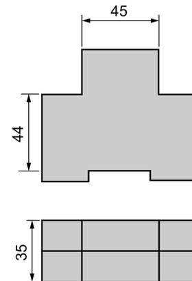
DD adapté pour la coupure du circuit aux dimensions indiquées dans le schéma (d'après la norme DIN 43880).
