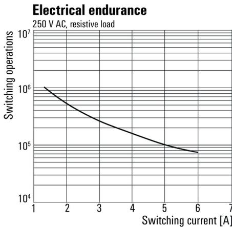
Durée de vie électrique 230 V AC resistive load
