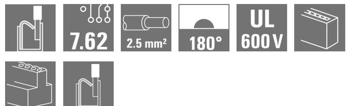
Connecteur mâle inversé à 180° avec raccordement PUSH-IN pour câblage de terrain 2,5 mm<sup>2</sup> au pas de 7,62. En plus, convient idéalement comme solution de protection des doigts pour tensions inverses.
