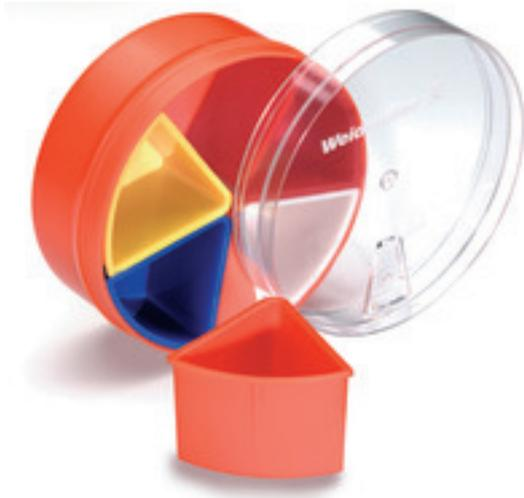
Embouts isolés de 0,14-16 mm en boîte plastique avec couvercle rotatif transparent. Une ouverture dans le couvercle permet une sélection et un montage ciblés . La rotation du couvercle en position fermée obstrue l'ouverture de distribution et évite le mélange des embouts.
