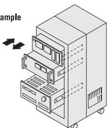
⚠ Séparer d'abord les rails et monter chaque rail sur les unités d'installation, puis fixer les rails séparés sur les rails montés.
