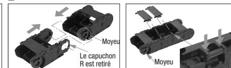
Ouvrir les rabats et retirer le capuchon R des maillons de connexion. Insérer le côté moyen en premier puis pousser l'ensemble des maillons des deux côtés. Confirmer la connexion d'un moyen, replacer le capuchon R déposé pour l'adapter à la rainure du porte-câbles et restaurer les rabats.
