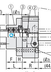
Ne pas utiliser sans insérer l'arbre fileté (serrage à vide). Il peut se déformer, ce qui le rend inutilisable. Q8 ne contient pas de collier pour levier de serrage. Les dimensions de montage du levier de serrage seront identiques à celles du type large. Le levier de serrage ne peut pas être monté sur le côté opposé.
