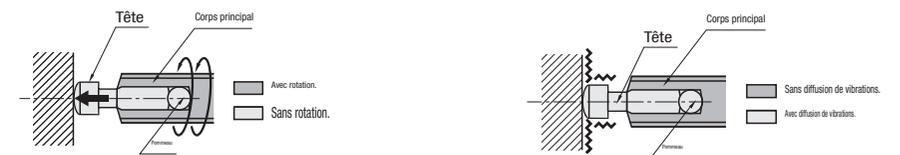
**Caractéristiques** : malgré la rotation de la vis, la tête de vis en contact avec la pièce ne tourne pas, afin d'éviter qu'elle n'endommage la pièce.
