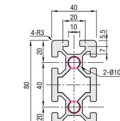
**Profils extrudés à longueur configurable**
