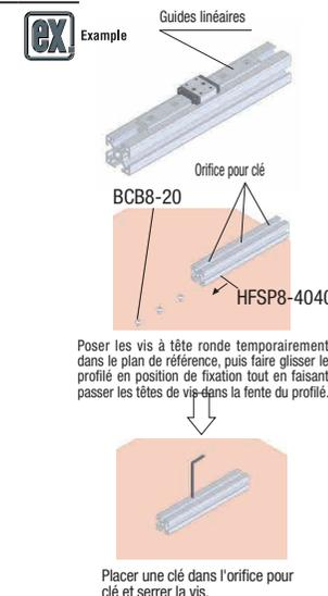
Poser les vis à tête ronde temporairement dans le plan de référence, puis faire glisser le profilé en position de fixation tout en faisant passer les têtes de vis dans la fente du profilé.
