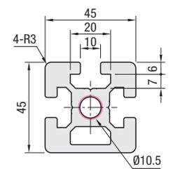
Profils extrudés à longueur configurable
