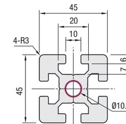
Caractéristiques : Extrusions carrées en aluminium de 45mm à 1 fente et avec un côté plat
