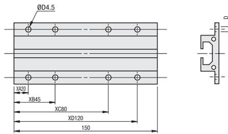
Des trous sont percés sur les rangées supérieure et inférieure.
