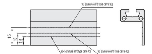
La sélection de V détermine les distances entre la ligne médiane et les trous pour que les deux extrusions soient également plates pour chaque taille d'extrusion.
