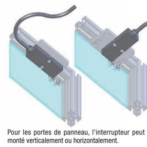
Pour les portes de panneau, l'interrupteur peut être monté verticalement ou horizontalement.
