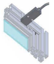
Pour les portes de profilé, l'interrupteur peut être monté perpendiculairement au profilé uniquement.
