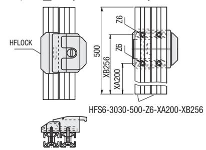
Exemples de modifications d'usinage de profilés extrudés contre-alésés pour le montage du type HFLOCK
