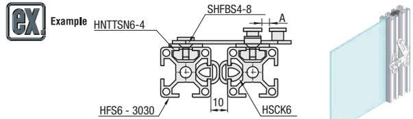
⚡ L'écart A doit être supérieur à 4mm.
