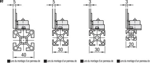
• Lors du montage d'un panneau de 5mm d'épaisseur sur un type carré 40
