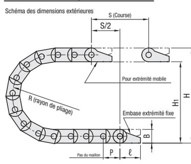
Matériau : Plastique spécial Plage de temp. -30°C ~ 100°C Norme d'inflammabilité UL94-V2
